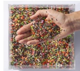
***Abfälle, die bei der Skiproduktion anfallen, wurden gesammelt, recycelt und in der Seitenwangenkonstruktion der Addikt-Reihe wiederverwendet.***
